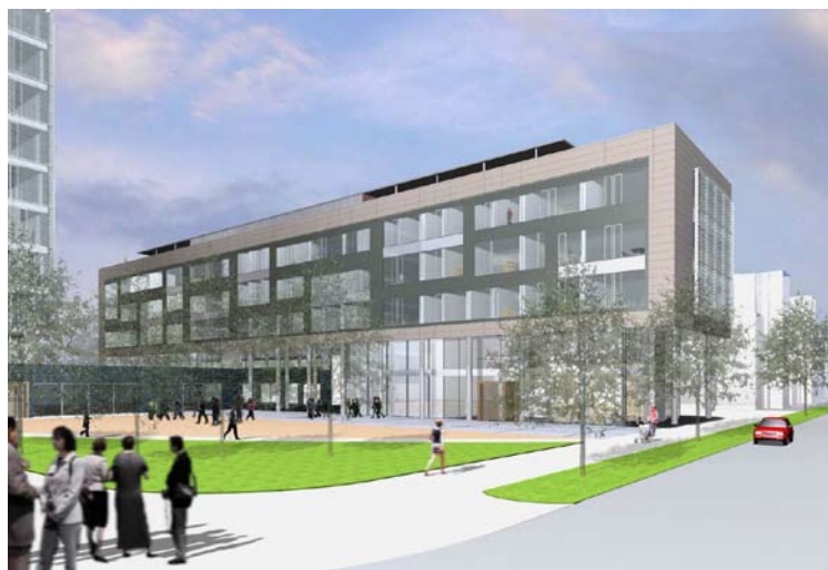
Figur 4.6 Norrfasad med 46% fönsterandel, såsom den planerades under systemskedet.
