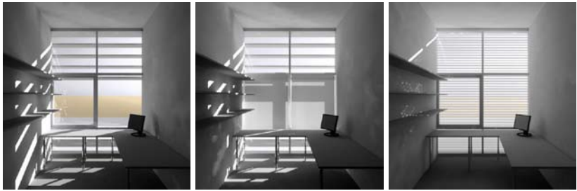
Figur 5.2 Exempel på jämförelse av designalternativ, simulering av dagsljus i Radiance av uppglasat kontor med utvändiga lameller (1), komletterad med invändig gardin på mitten (2) eller ersatt med en ljusinlänkande fasadpersienn (3). I den tredje bilden är kontrasterna lägst vilket möjliggör bäst synförhållanden för datorarbete.
