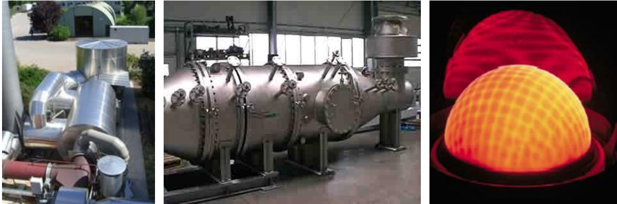
Figur 4: Två system för katalytisk oxidation av brännbara gaser samt katalytisk MatriX-brännare i funktion (källa: Dürr Clean Technology Systems AG, R.Scheuchl GmbH, Viessmann GmbH & Co. KG)
